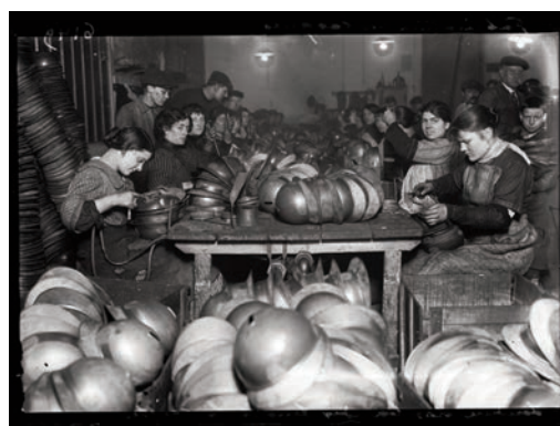
71771-11 Guerre 1914-1918. "La fabrication des casques et l'une des plus typiques industries de la guerre". Soudure des bandes tenant la coiffe et des anneaux de la jugulaire. Photographie parue dans le journal "Excelsior" du samedi 29 janvier 1916.
